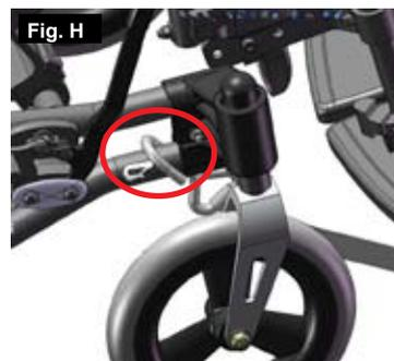
Positionnement du dispositif avant d'arrimage du fauteuil roulant et de l'étiquette d'arrimage (Fig. h).
