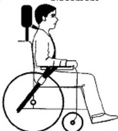
4. Le symbole d'arrimage (Fig. f) sur le châssis du fauteuil roulant indique la position des sangles de retenue du fauteuil roulant. Les sangles sont ensuite tendues après que les sangles avant aient été fixées pour sécuriser le fauteuil roulant.
