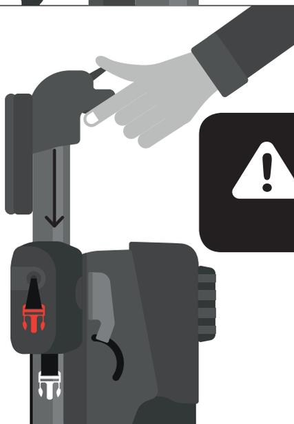
**Attention :** ne pas régler la hauteur totale pendant que l'utilisateur est installé dans le dispositif.
