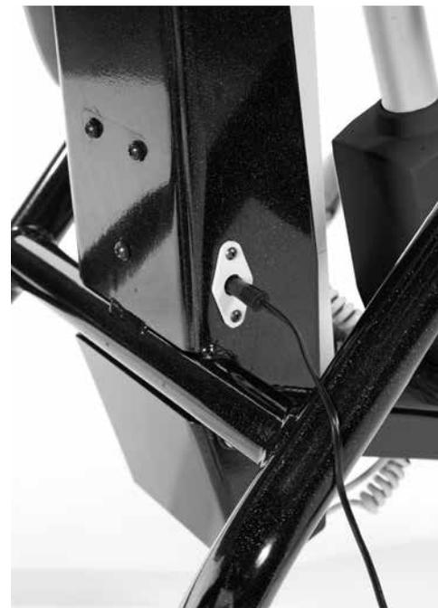
Dès le chargement terminé, mettre hors tension, enlever la prise de l'adaptateur et débrancher la fiche de la manette.
